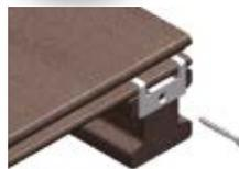
Die Dielen am Rand können mit einem Randclip befestigt werden. Dieser Clip wird von der Seite oder von oben mit der Unterkonstruktion verschraubt (z. B. Terrassenrand an einer Wand). Er ermöglicht es, die Abschlussdielen ohne sichtbare Schrauben zu befestigen.
